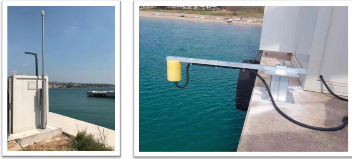
Şekil-3: KRDAE-BDTİM tarafından Marmara'da kurulumu gerçekleştirilen çok-disiplinli deprem-tsunami gözlem istasyonlarına ilişkin bazı görseller.
