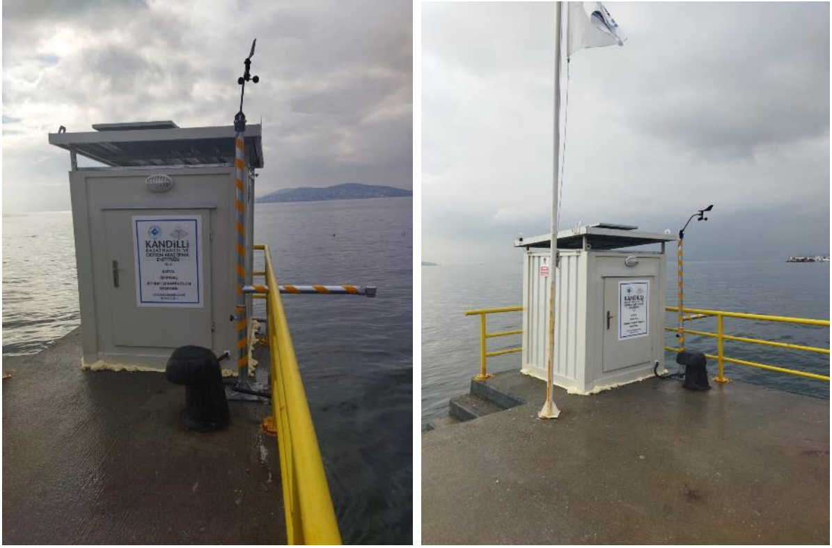
Şekil 1. Kartal'da 24 Ocak 2024 tarihinde kurulan çok disiplinli tsunami gözlem ve erken uyarı istasyonu.
